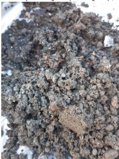
Foto 9: Vrijkomende grond t.p.v. boring 201 (0,75-1,0 m-mv)
