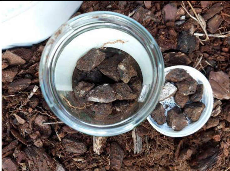
Foto 11: Deellocatie 3; Hoogovenslakken ter plaatse van boring 304 (traject 10-50 cm-mv)
