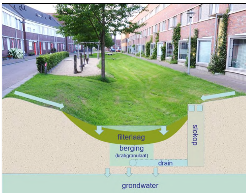
Figuur 23: Dwarsdoorsnede van een wadi. Bron: Kennisportaal Klimaatadaptatie.
