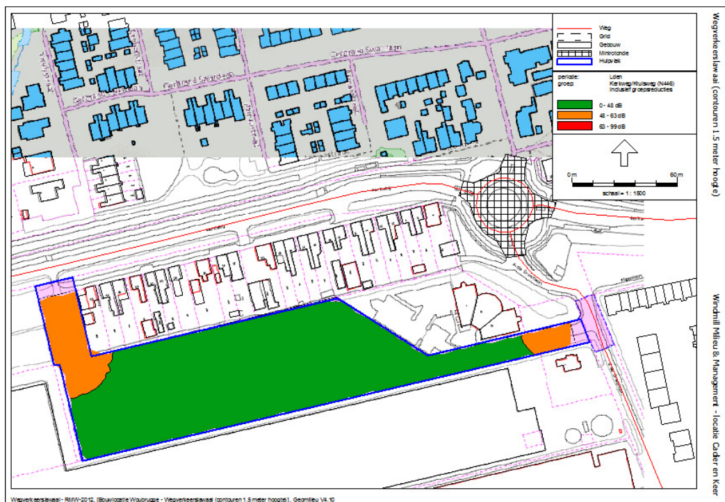
Figuur 4.1 Wegverkeerslawaai t.g.v. Kerkweg/Kruisweg (N446) op 1,5 m. hoogte incl. 5 dB aftrek art. 110g Wgh.
