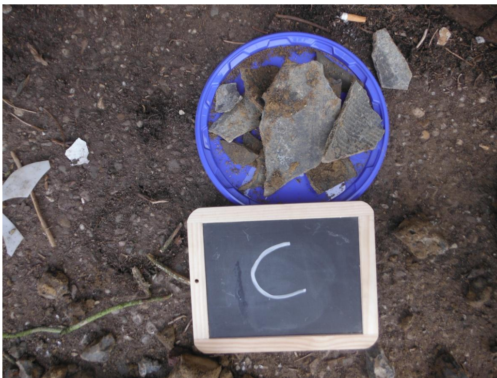
Foto 8. Asbestverdacht materiaal sleuf C
