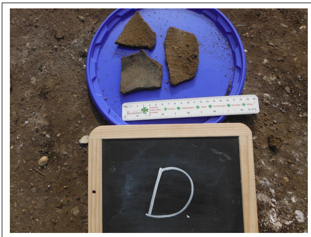
Foto 11. Asbestverdacht materiaal sleuf D
