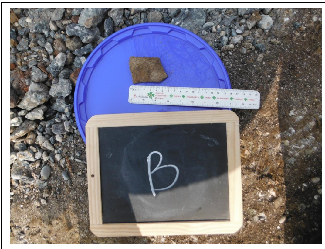
Foto 5. Asbestverdacht materiaal sleuf B
