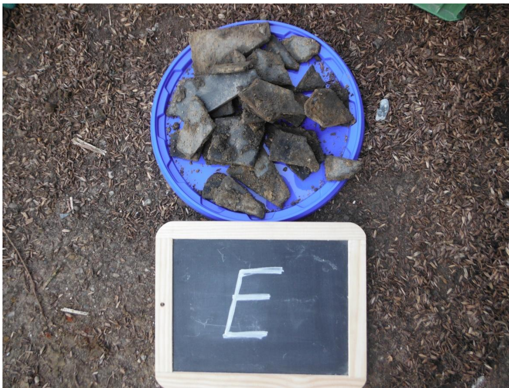
Foto 14. Asbestverdacht materiaal sleuf E
