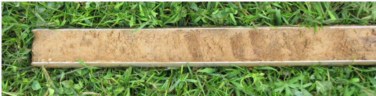
Figuur 11: Foto van boring 1; rechts zijn duidelijk zandlaagjes te zien
