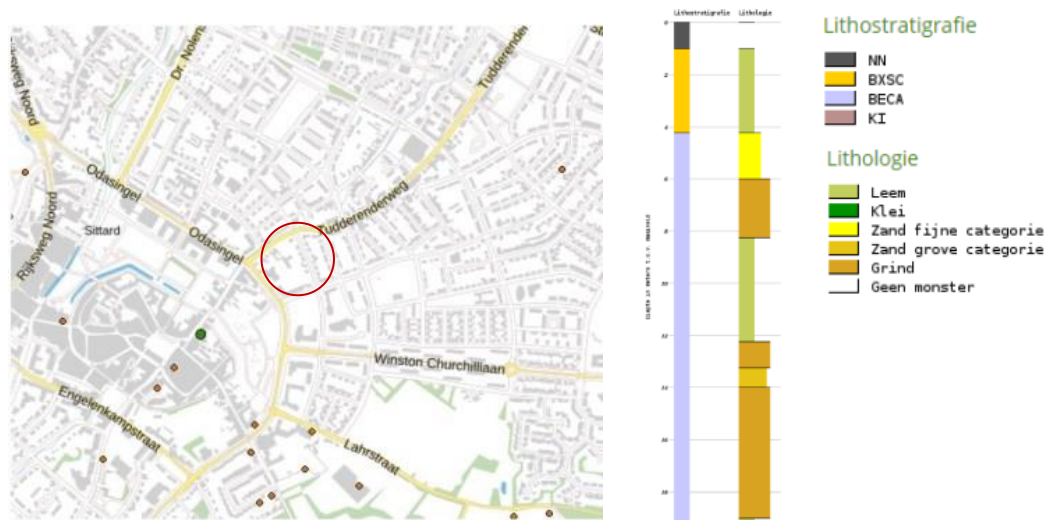
Figuur 6: Geologisch profiel
