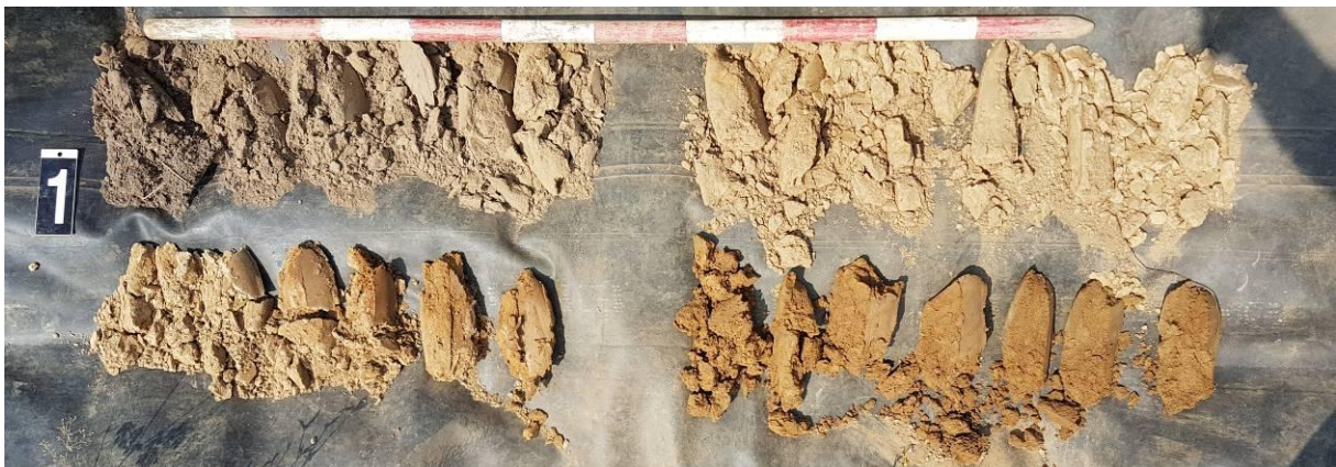
Figuur 21: Foto van boorprofiel 1, uitgelegd per meter van linksboven naar rechtsonder.
