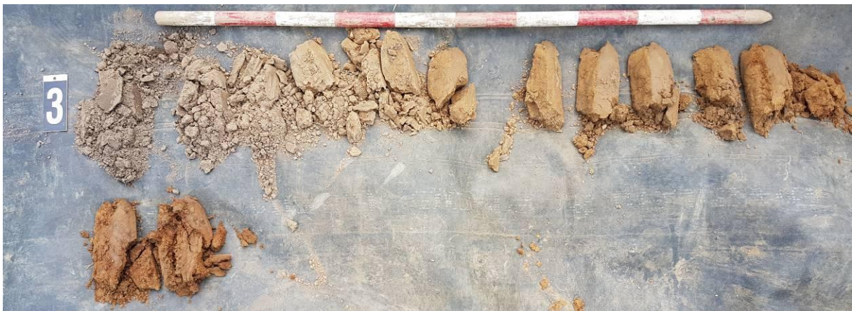
Figuur 22: Foto van boorprofiel 3, uitgelegd per meter van linksboven naar rechtsonder.
