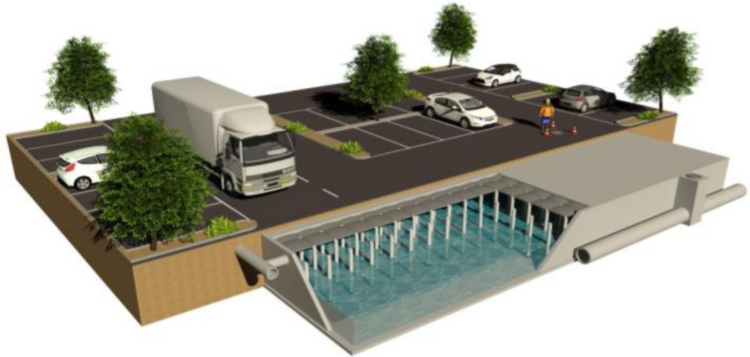
Afbeelding 2 infiltratiekelder (Bron: Waterblock)
