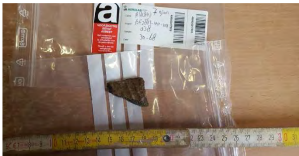
Asbestverdacht materiaal in gat 038
