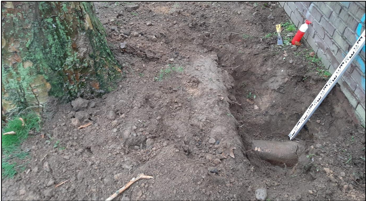
Figuur 20. Proefsleuf 3 en de aangetroffen stabiliteitswortel op \pm 200 centimeter gemeten vanuit het hart van de boom.
