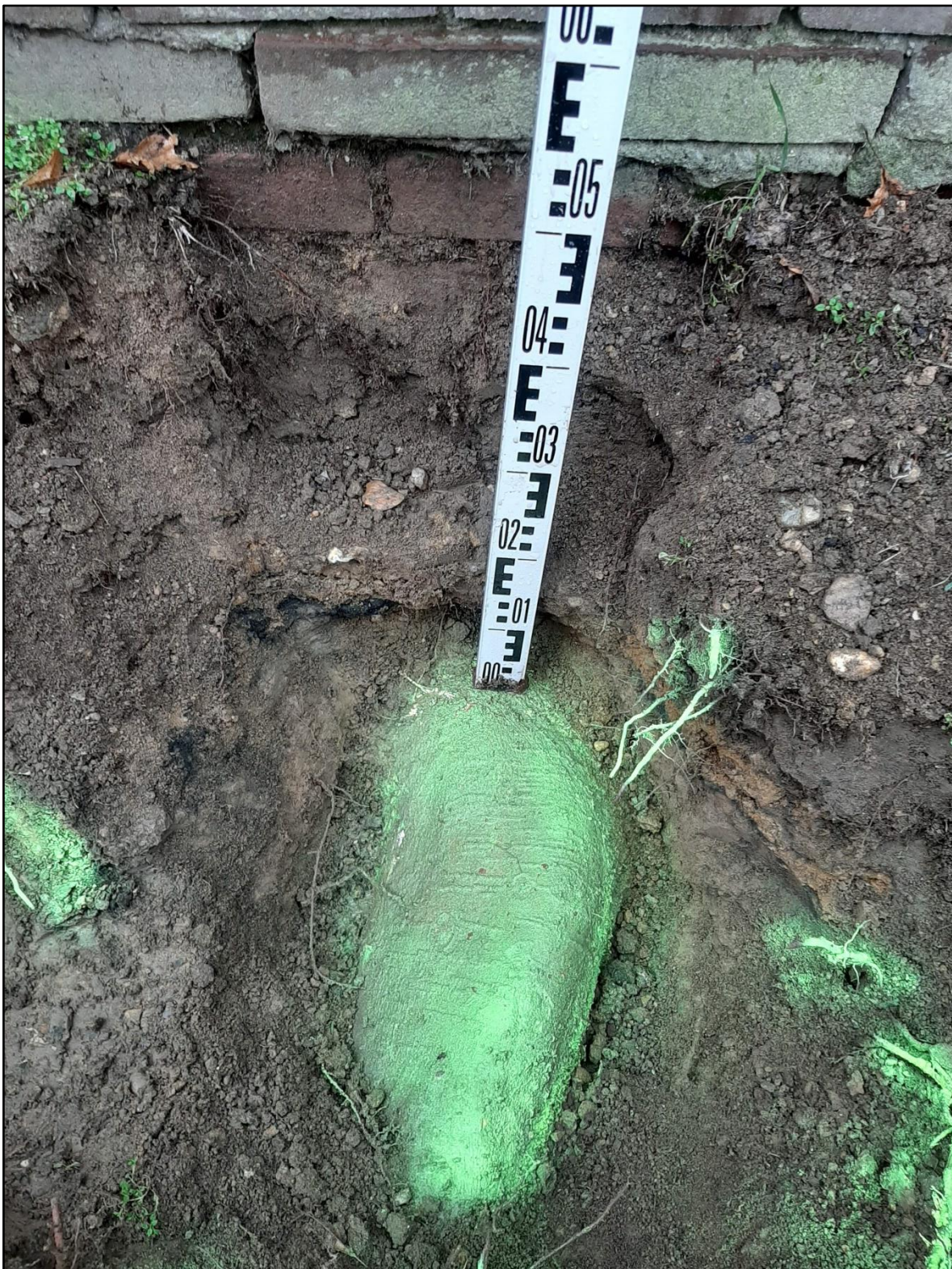
Figuur 22. Proefsleuf 3. Diepte aangetroffen stabiliteitswortel ( \pm 55 centimeter -maaiveld).
