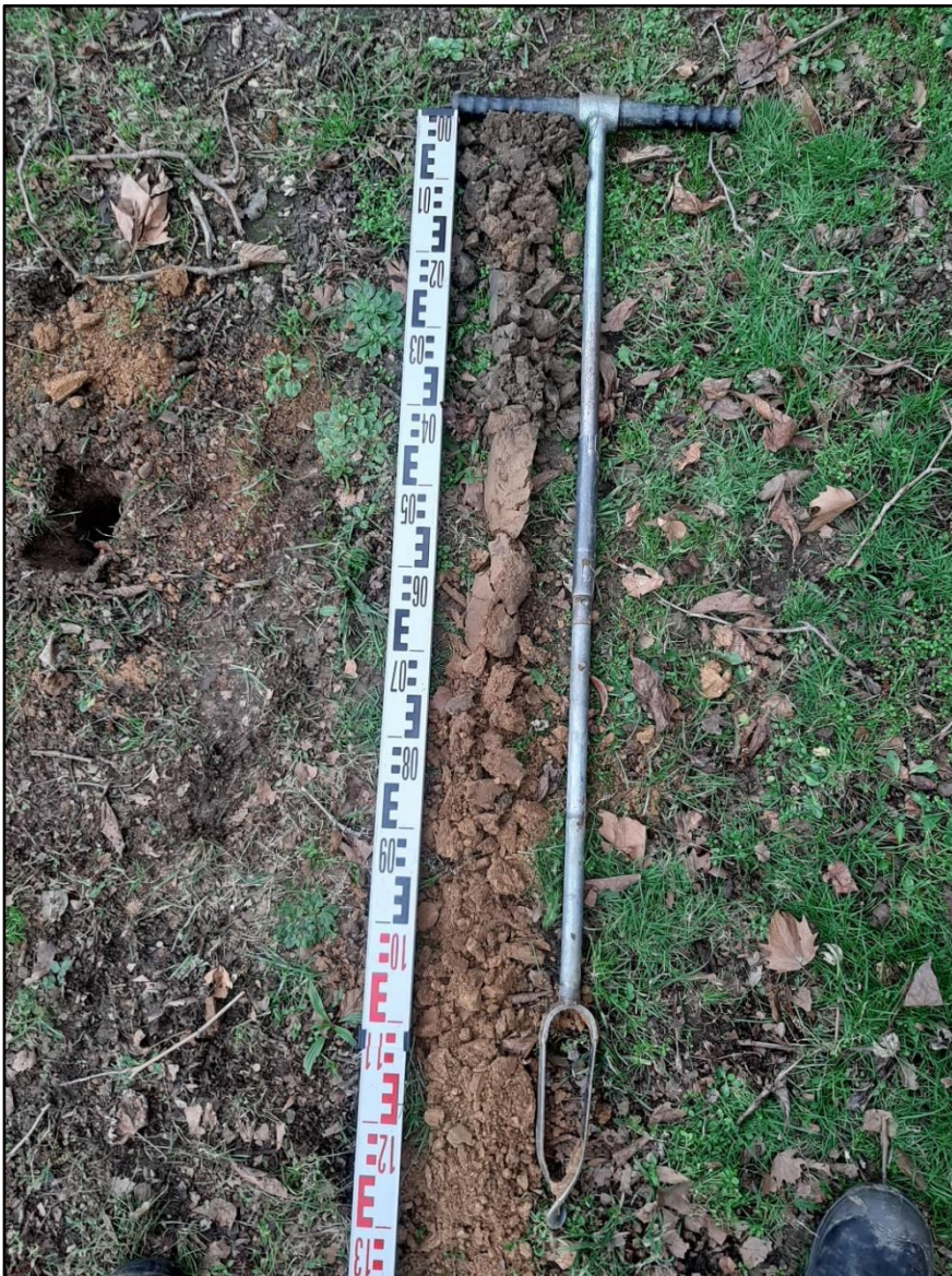
Figuur 7. Bodemprofiel op onderzoekslocatie (tot 120 cm –maaiveld).
