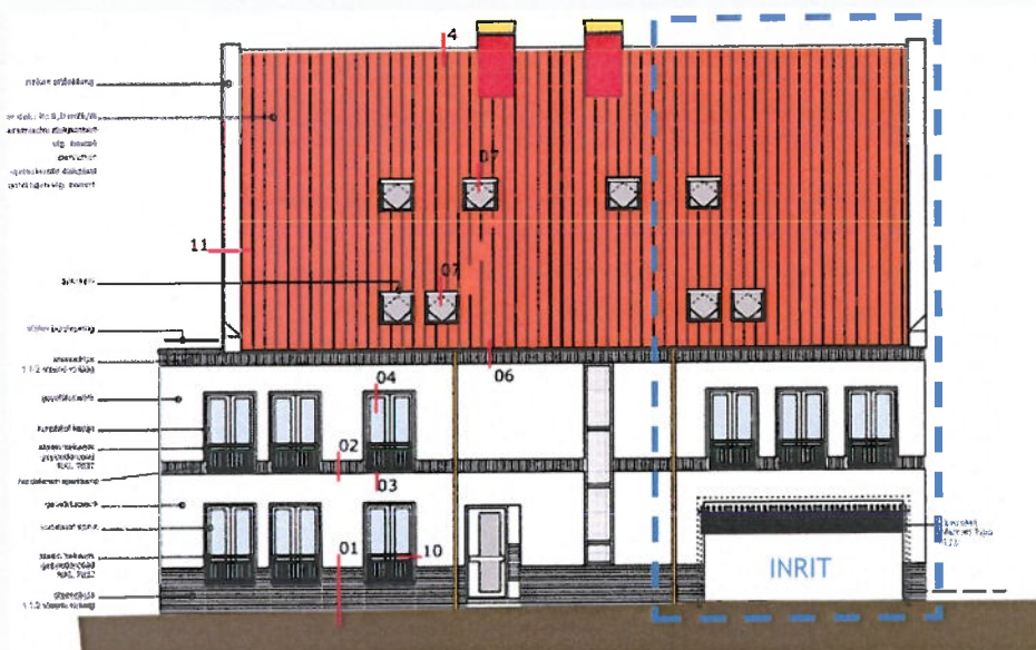
figuur 1: gevelaanzicht straatzijde met inrit parkeergarage en geluid belaste verblijfsruimten (binnen gestreept kader)
