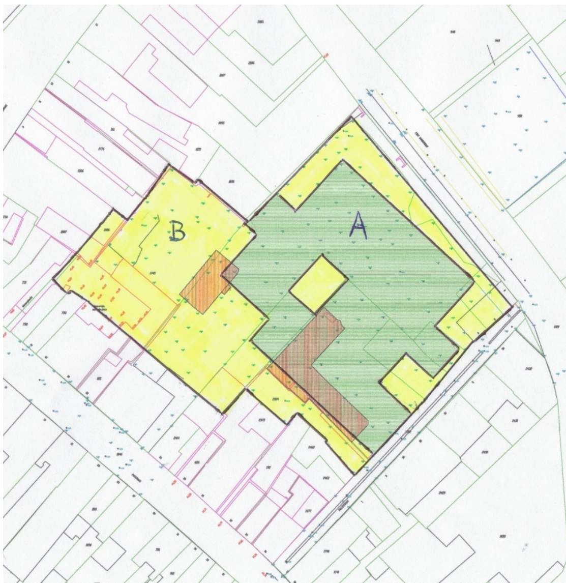
Figuur 2. Plangebied (4278 m 2 ) en bouwplannen. In groen de ligging van de nieuw aan te leggen parkeerkelder (2179 m 2 , Zone A). In rood, de bestaande kelders. In geel het overige gebied (2099 m 2 , Zone B). Centraal in het plangebied de te behouden Moutschuur (geel). Zie ook bijlagen 2, 4 en 5
