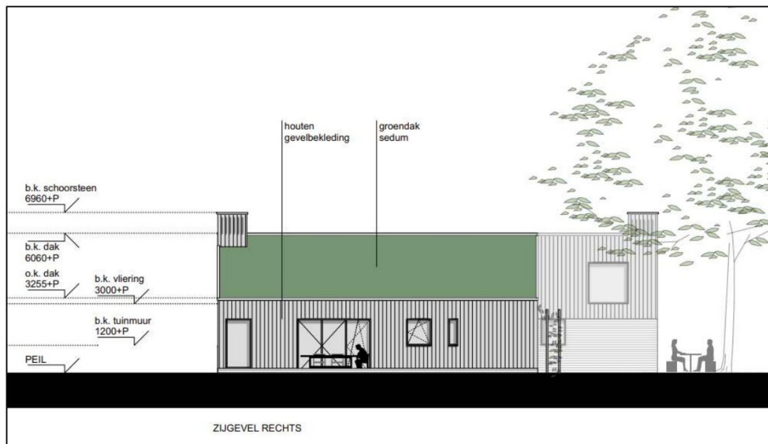
Zijgevel rechts (bron: Vullings de Moor Architecten)
