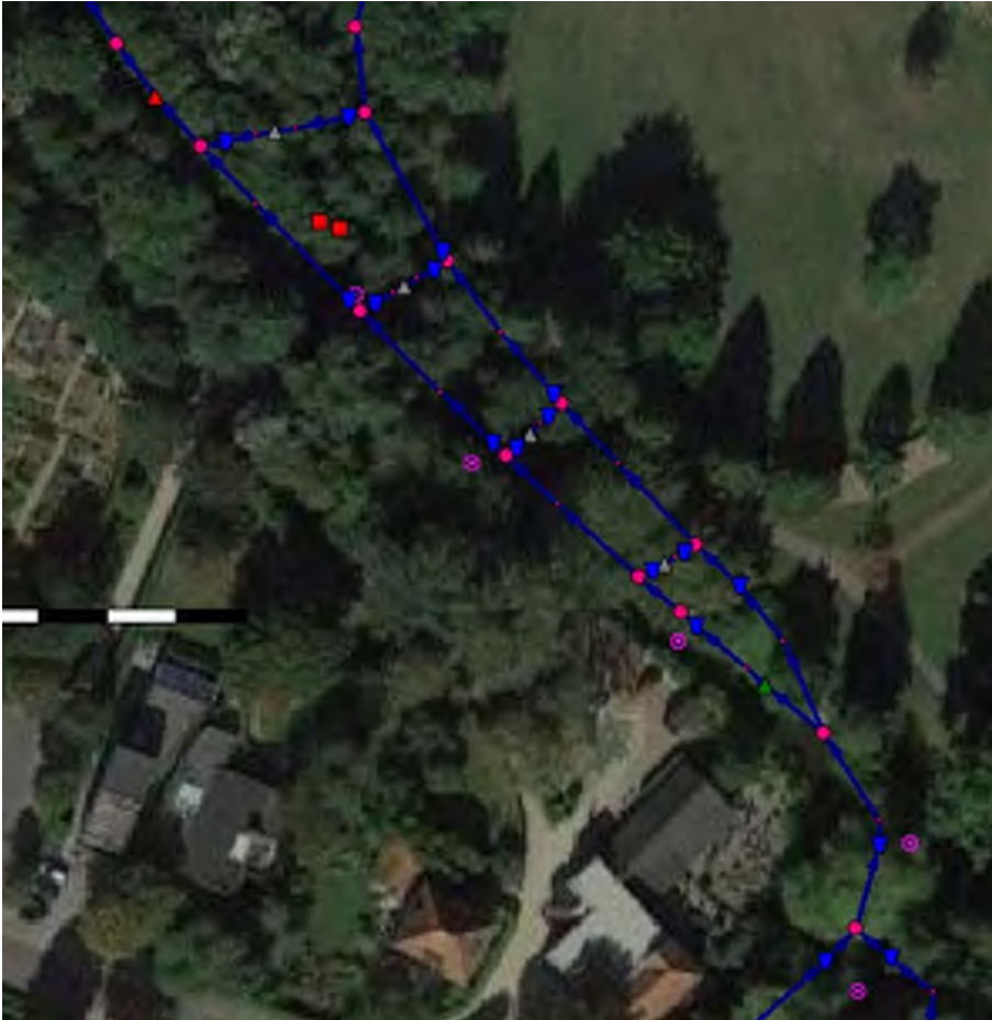
Figuur 15 De drempel is geschematiseerd als een viertal parallel liggende takjes met op elk daarvan een Universal Weir.
