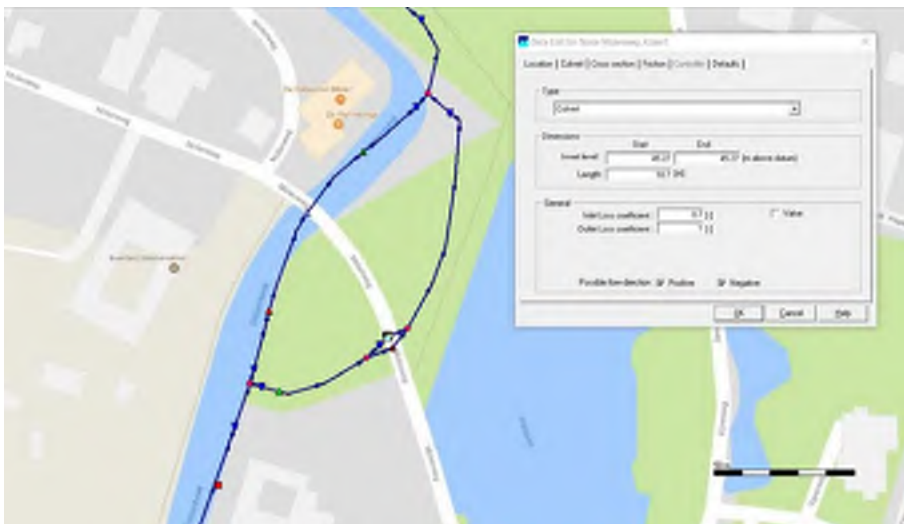
Figuur 7 De kokers zijn toegevoegd aan de modelschematisatie in de vorm van twee parallel liggende duikers.
