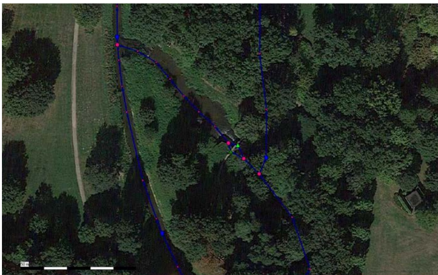
Figuur 8 De oude Steenen Sluis hebben wij geschematiseerd als een onderlaat met parallel daaraan een stuw. Op deze wijze kan zowel het spuien als overstorten van de sluis worden gemodelleerd.
