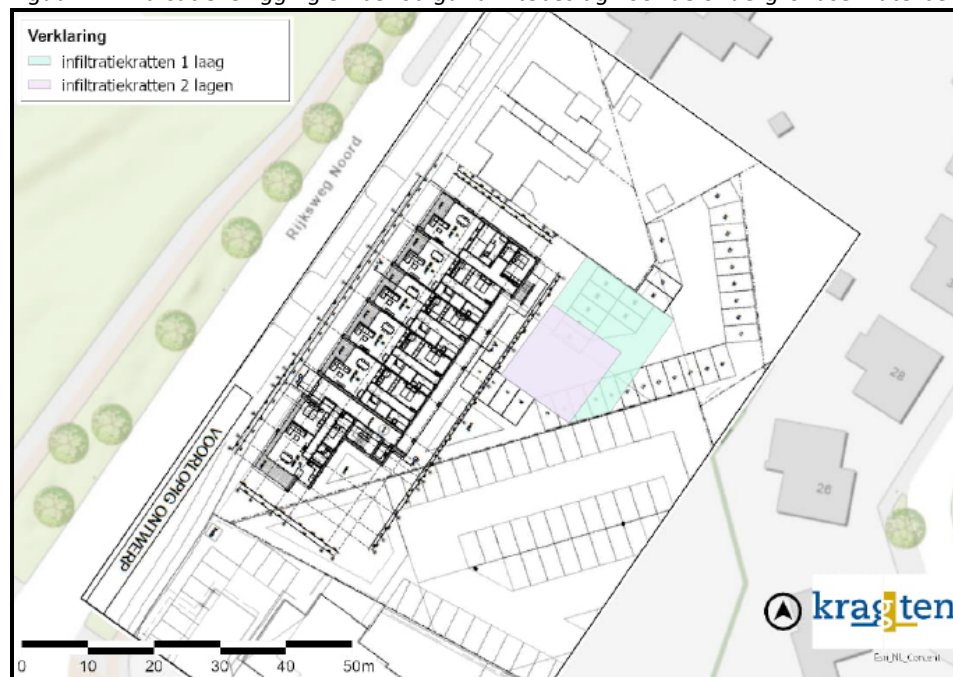
Figuur 14: Indicatieve ligging en benodigd ruimtebeslag voor de ondergrondse waterberging op eigen terrein
