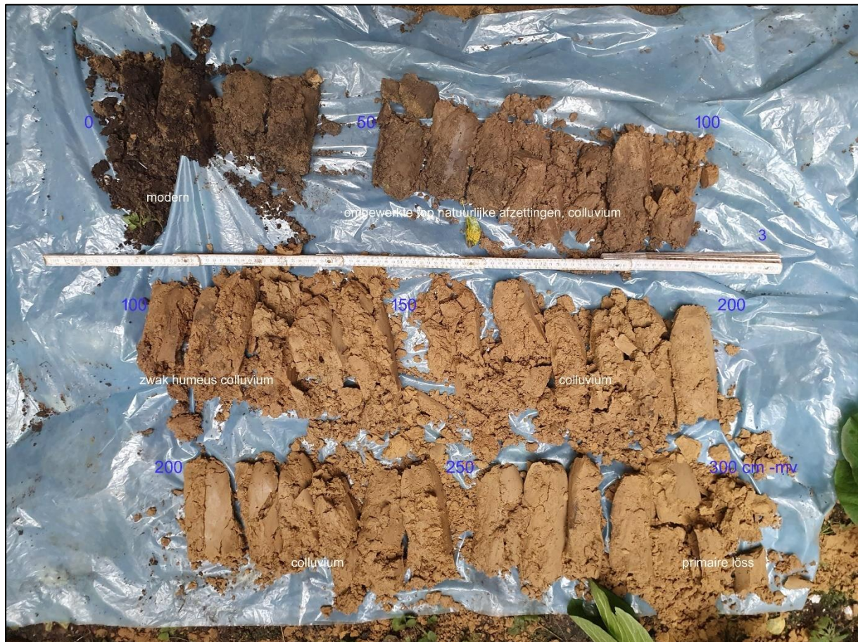
Figuur 19: De van links naar rechts en van boven naar beneden uitgelegde boring 3.
