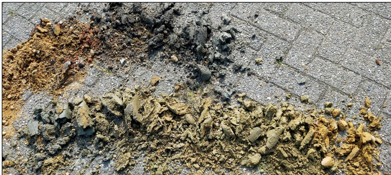
Figuur 8. Boorprofiel van boring 1 leeswijze van links naar rechts en van boven naar beneden.
