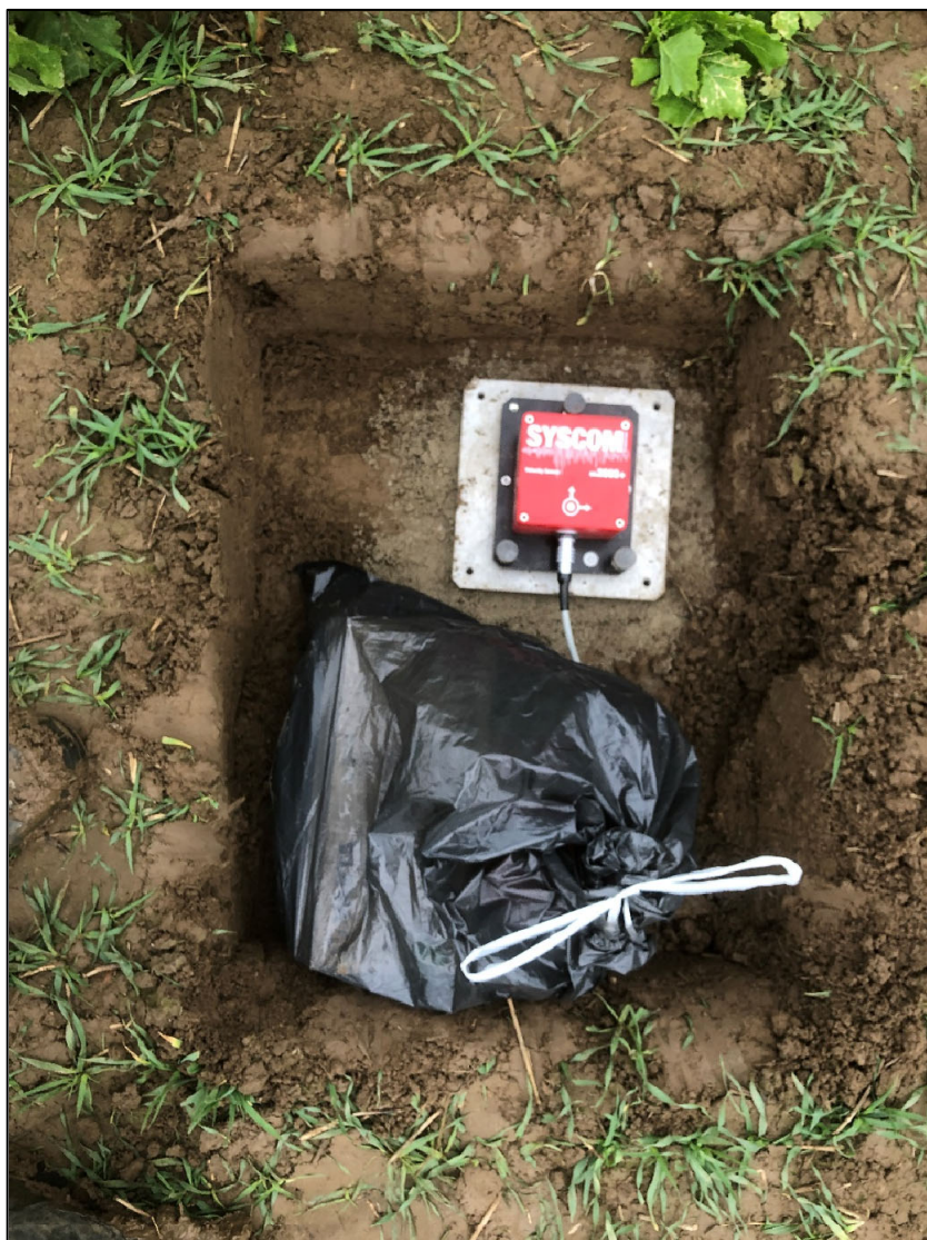
Figuur 3.2: De trillingssensor ingegraven bij meetpunt 1
