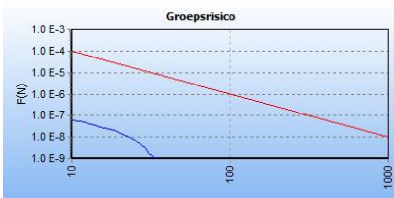
5.4 Figuur 5.4 FN curve voor 7473_leiding-Z-540-46-deel-1 van N.V. Nederlandse Gasunie voor de kilometer tussen stationing 0.00 en stationing 0.00
