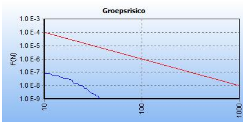
5.5 Figuur 5.5 FN curve voor 7493_leiding-Z-540-01-deel-1_incl verl van N.V. Nederlandse Gasunie voor de kilometer tussen stationing 2490.00 en stationing 3490.00
