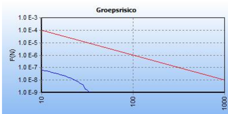
5.5 Figuur 5.5 FN curve voor 7493_leiding-Z-540-01-deel-1_incl verl van N.V. Nederlandse Gasunie voor de kilometer tussen stationing 2010.00 en stationing 3010.00
