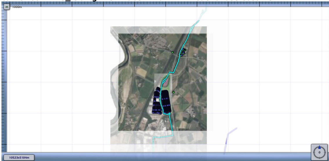
Figuur 4.2 Kilometer leiding behorende bij de maximale overschrijding van de FN-curve voor 7473_leiding-A-521-deel-1 van N.V. Nederlandse Gasunie
