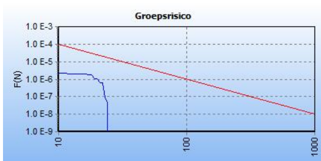
Figuur 17: De fN-curve voor deze kilometer leiding (leiding Z-540-26 exclusief de verlegging).
