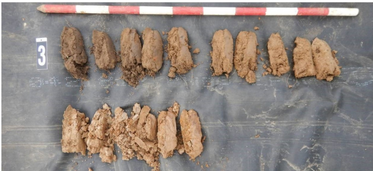
Figuur 22: Foto van boring 3, uitgelegd per meter van links boven naar rechts onder.
