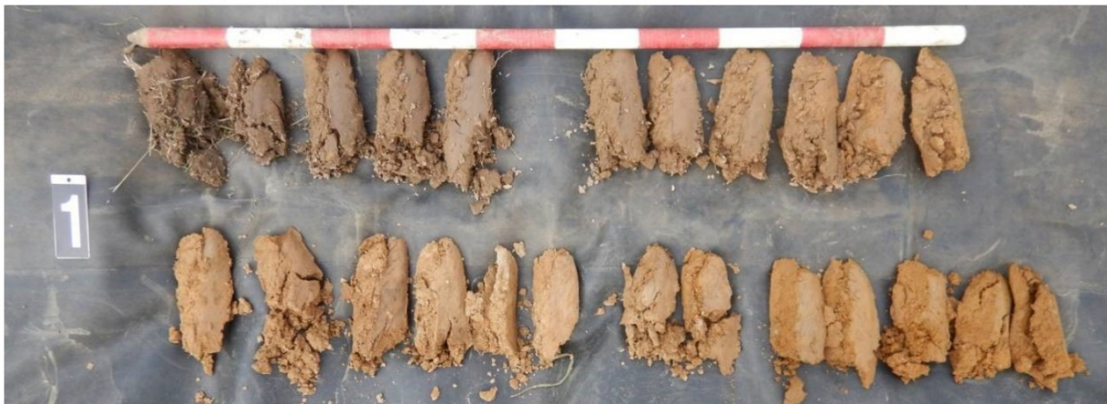
Figuur 20: Foto van boring 1, uitgelegd per meter van links boven naar rechts onder.
