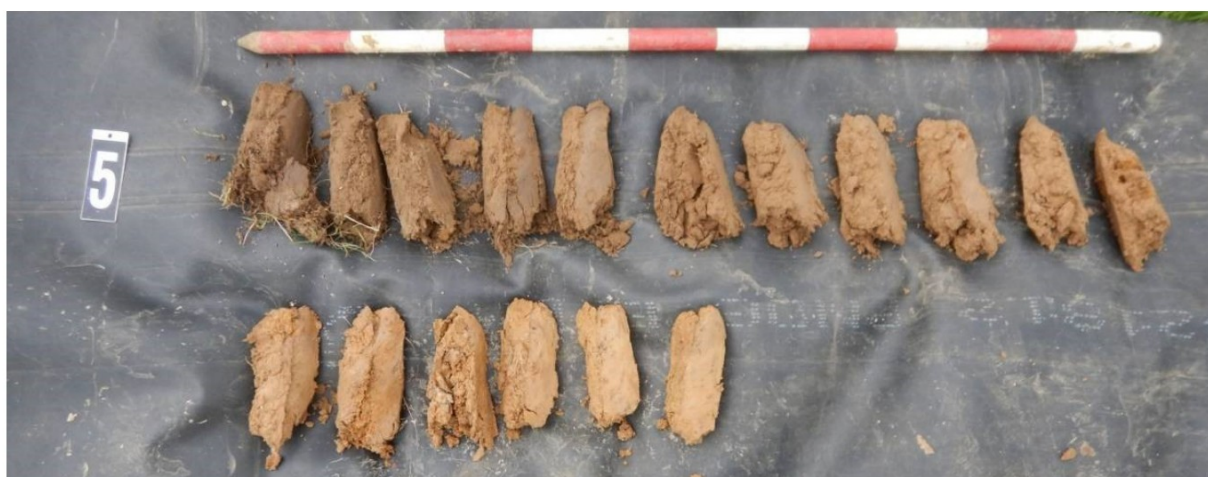
Figuur 24: Foto van boring 5, uitgelegd per meter van links boven naar rechts onder.
