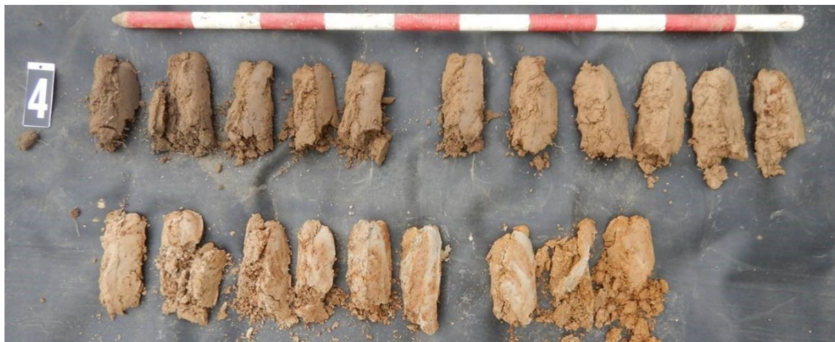
Figuur 23: Foto van boring 4, uitgelegd per meter van links boven naar rechts onder.
