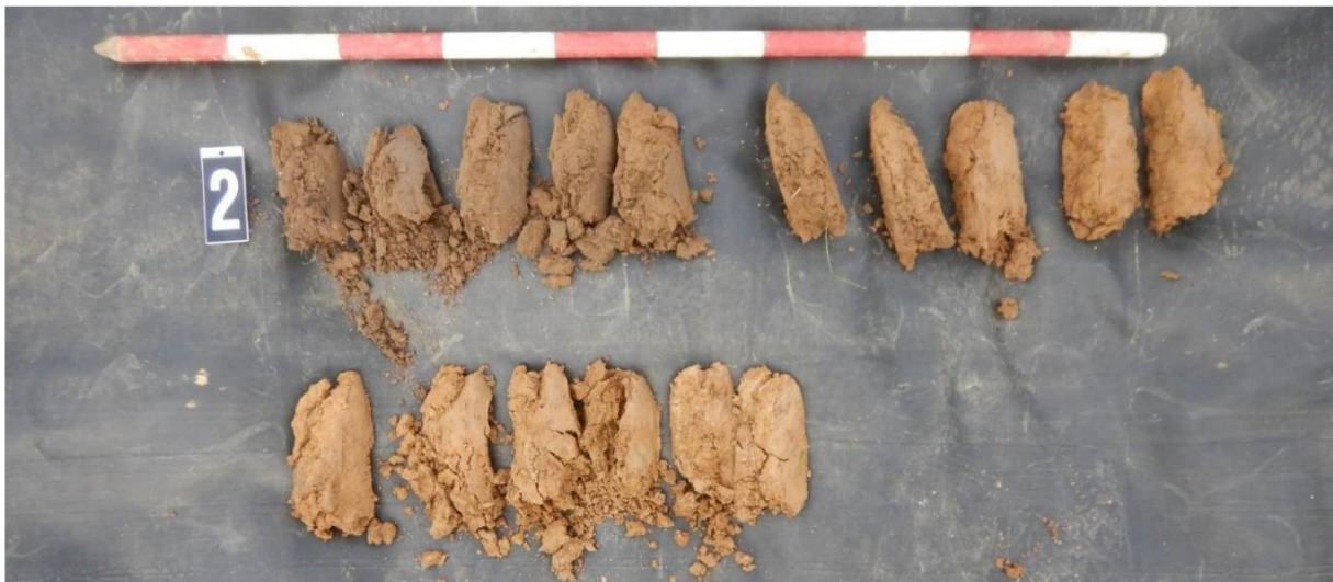
Figuur 21: Foto van boring 2, uitgelegd per meter van links boven naar rechts onder.
