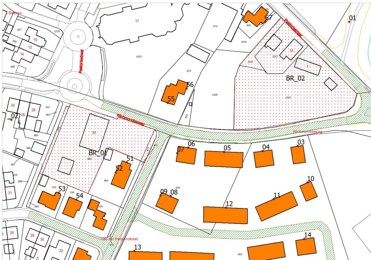
Figuur 3: Weergave rekenmodel met oppervlaktebronnen, gebouwen en waarneempunten
