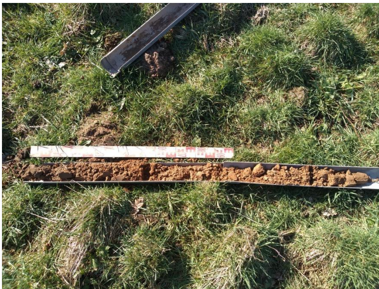
Afbeelding 19: Foto van het boorprofiel van boring 3 met v.l.n.r. de akkerlaag met daaronder verspoeld dekzand met grijze leembrokjes en lichtbruin fijn verspoeld dekzand.
