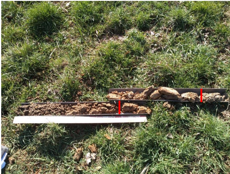
Afbeelding 20: Foto van het boorprofiel van boring 1 met v.l.n.r. de gevlekte akkerlaag met daaronder een pakket grijze gerijpte roestige hoogvloedleem overgaand in grof beddingzand met grindjes.
