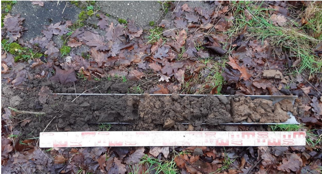
Afbeelding 15: Foto van het boorprofiel van boring 4 met v.l.n.r. de subrecente bouwvoor, de geel/grijs/bruine gevlekte ophogingslaag (Ap1-horizont) en het grijze fijne dekzandpakket (C-horizont)..
