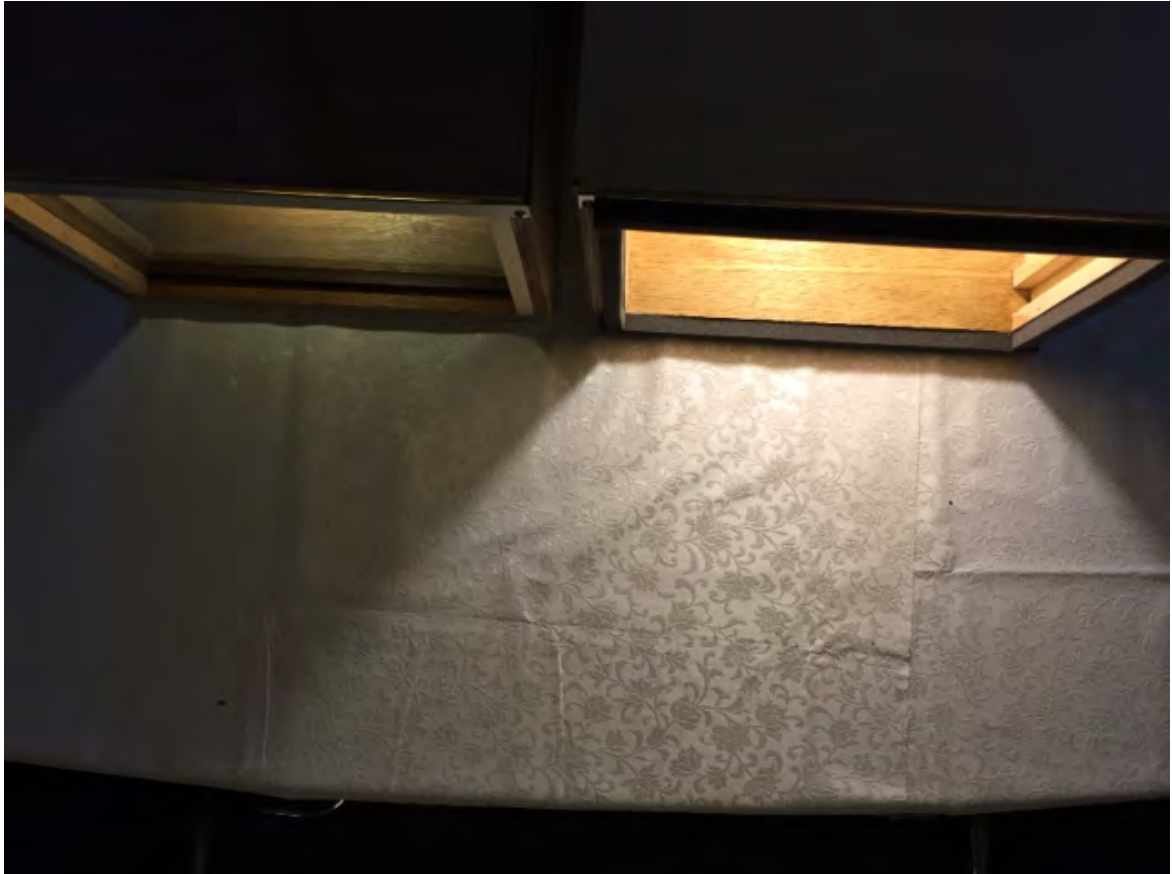
Links de uitstraling van een inbouwarmatuur met grijs glas met standaard zonwering en grijs interieur; rechts de uitstraling van blank glas en een opbouwarmatuur en wit interieur.
