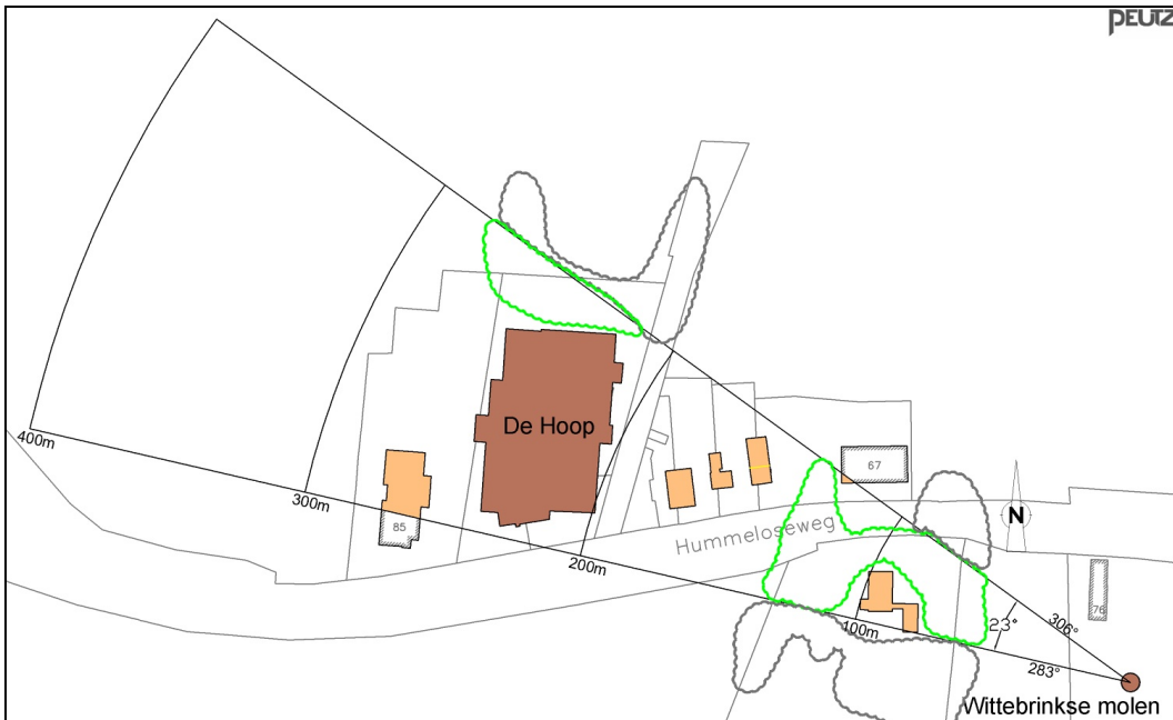
Figuur 7: Belemmerende sector bestaande bebouwingscontour De Hoop.
