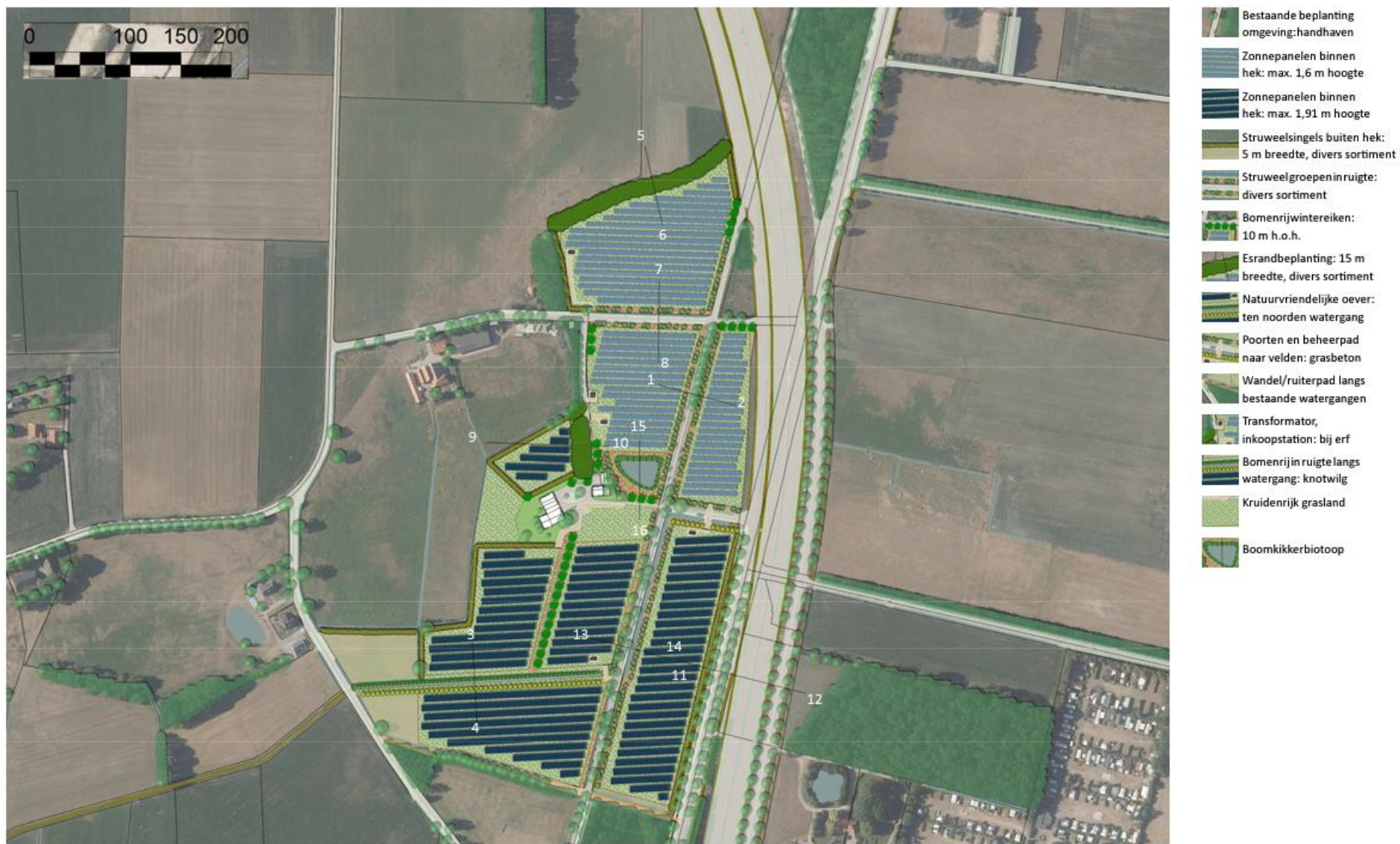
Figuur 9: Inpassing van Zonneveld Hupsel. Panelen met lichtblauwe kleur 1,60 m hoog, panelen met donkerblauwe kleur 1,91 m hoog (bron: Landschappelijk inpassingsplan Zonneveld Hupsel).
