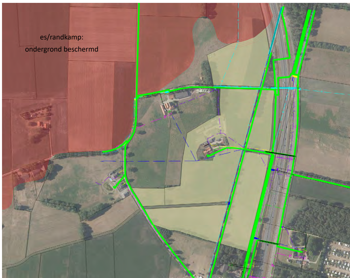
Afbeelding 21. Ondergrond met kabels/leidingen als belemmering voor toekomstbestendige groeiplaats bomen.
