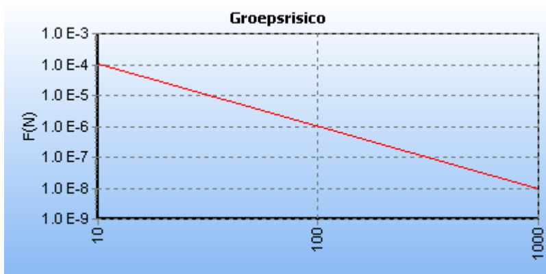
5.1 Figuur 5.1 FN curve voor N-569-82 van N.V. Nederlandse Gasunie voor de kilometer tussen stationing 0.00 en stationing 410.00
