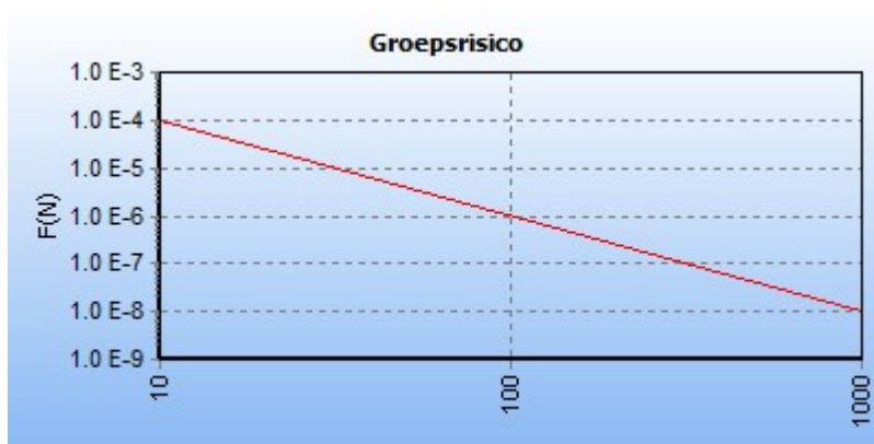
5.5 Figuur 5.5 FN curve voor 2081_leiding-N-560-04-deel-1 van N.V. Nederlandse Gasunie voor de kilometer tussen stationing 0.00 en stationing 1000.00
