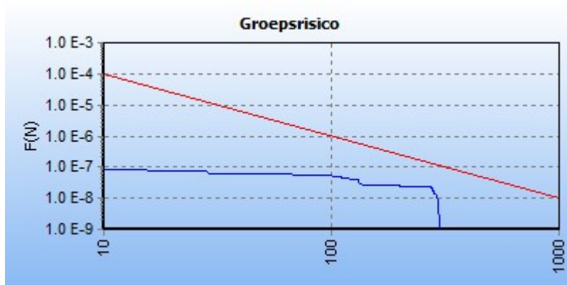
5.4 Figuur 5.4 FN curve voor 2081_leiding-N-560-03-deel-1 van N.V. Nederlandse Gasunie voor de kilometer tussen stationing 0.00 en stationing 1000.00
