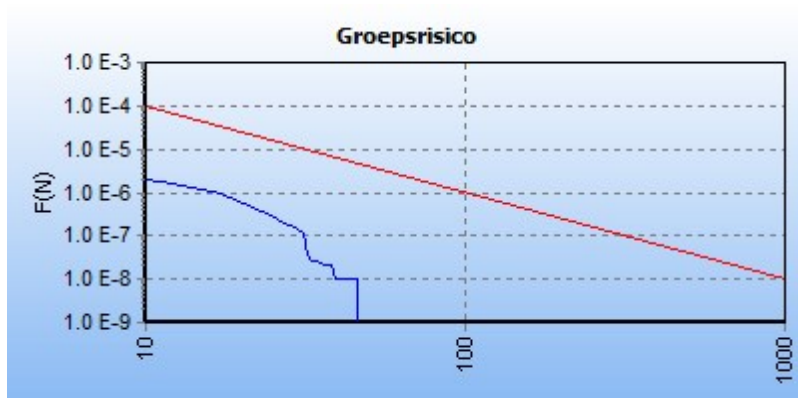
5.8 Figuur 5.8 FN curve voor 2082_leiding-N-569-81-deel-1_incl verl van N.V. Nederlandse Gasunie voor de kilometer tussen stationing 1480.00 en stationing 2480.00
