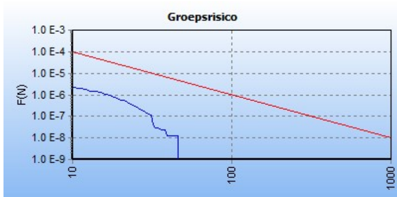
5.5 Figuur 5.5 FN curve voor 2079_leiding-N-569-82-deel-1 van N.V. Nederlandse Gasunie voor de kilometer tussen stationing 0.00 en stationing 410.00
