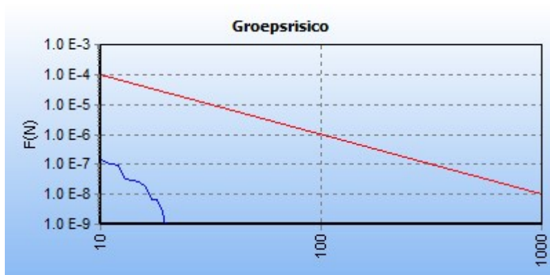
5.10 Figuur 5.10 FN curve voor 2084_leiding-N-569-80-deel-1_incl verl van N.V. Nederlandse Gasunie voor de kilometer tussen stationing 6090.00 en stationing 7090.00
