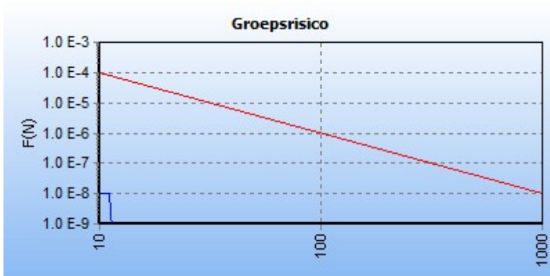
5.2 Figuur 5.2 FN curve voor 2078_leiding-A-529-04-deel-1 van N.V. Nederlandse Gasunie voor de kilometer tussen stationing 3420.00 en stationing 4420.00
