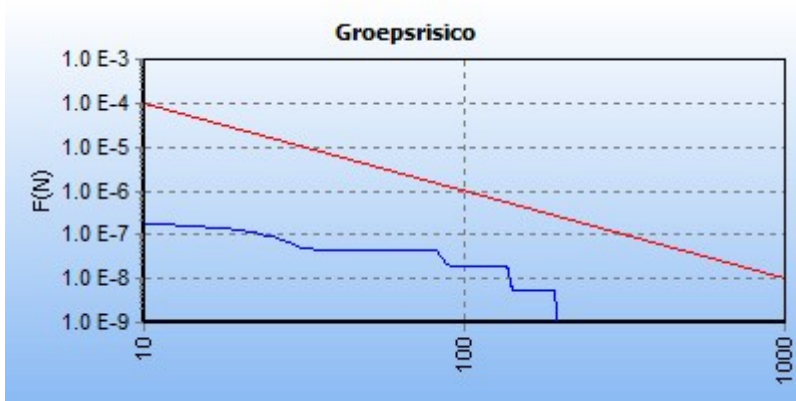
5.2 Figuur 5.2 FN curve voor 2078_leiding-A-529-04-deel-1 van N.V. Nederlandse Gasunie voor de kilometer tussen stationing 3420.00 en stationing 4420.00
