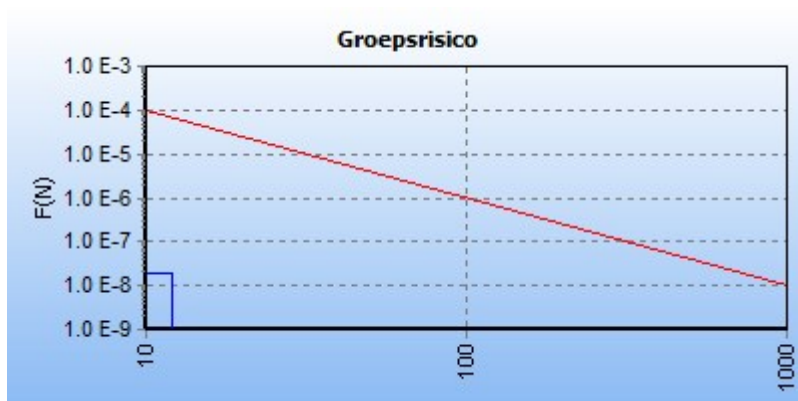
5.10 Figuur 5.10 FN curve voor 2078_leiding-N-569-84-deel-1 van N.V. Nederlandse Gasunie voor de kilometer tussen stationing 3700.00 en stationing 4700.00
