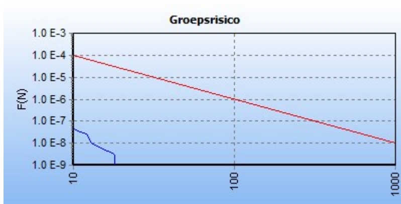
5.5 Figuur 5.5 FN curve voor 2080_leiding-A-634-deel-1 van N.V. Nederlandse Gasunie voor de kilometer tussen stationing 1610.00 en stationing 2610.00
