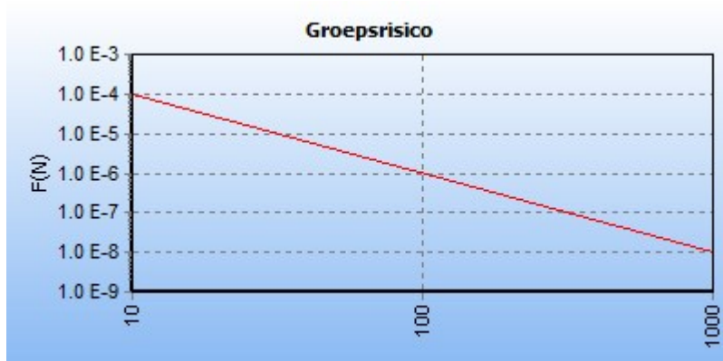
5.10 Figuur 5.10 FN curve voor 2078_leiding-N-569-84-deel-1 van N.V. Nederlandse Gasunie voor de kilometer tussen stationing 3700.00 en stationing 4700.00
