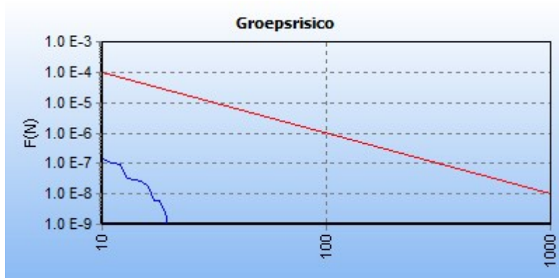
5.4 Figuur 5.4 FN curve voor 2079_leiding-N-569-81-deel-1_excl verl van N.V. Nederlandse Gasunie voor de kilometer tussen stationing 1450.00 en stationing 2450.00
