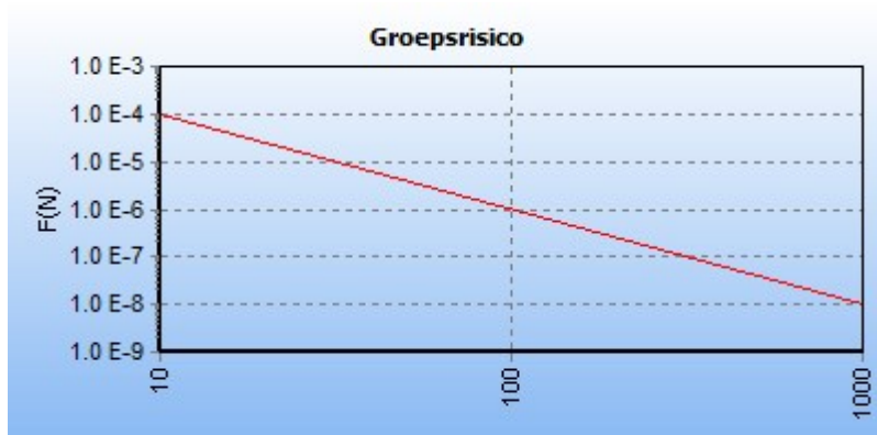
5.8 Figuur 5.8 FN curve voor 2082_leiding-N-569-81-deel-1_incl verl van N.V. Nederlandse Gasunie voor de kilometer tussen stationing 1480.00 en stationing 2480.00
