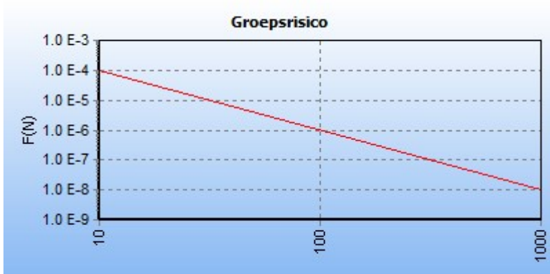
5.2 Figuur 5.2 FN curve voor 2079_leiding-N-569-66-deel-1 van N.V. Nederlandse Gasunie voor de kilometer tussen stationing 0.00 en stationing 400.00
