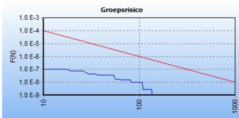
5.7 Figuur 5.7 FN curve voor 2079_leiding-N-569-84-deel-1_excl verl van N.V. Nederlandse Gasunie voor de kilometer tussen stationing 0.00 en stationing 1000.00
