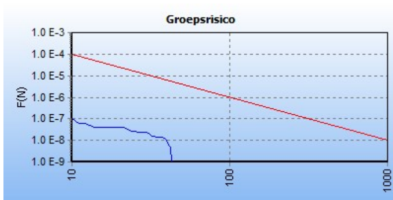
5.8 Figuur 5.8 FN curve voor 2078_leiding-N-560-08-deel-1 van N.V. Nederlandse Gasunie voor de kilometer tussen stationing 0.00 en stationing 0.00
