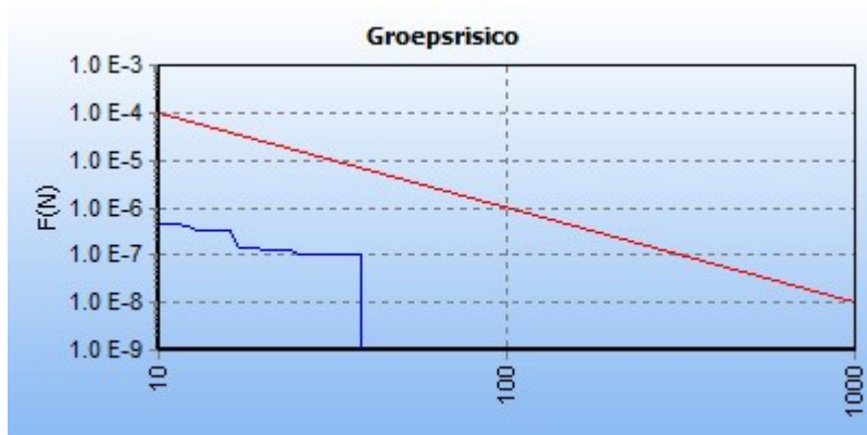
5.7 Figuur 5.7 FN curve voor 2078_leiding-N-560-07-deel-1 van N.V. Nederlandse Gasunie voor de kilometer tussen stationing 900.00 en stationing 1640.00
