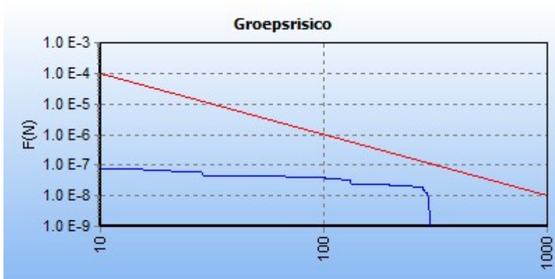
5.2 Figuur 5.2 FN curve voor 2081_leiding-A-579-deel-1 van N.V. Nederlandse Gasunie voor de kilometer tussen stationing 2980.00 en stationing 3980.00
