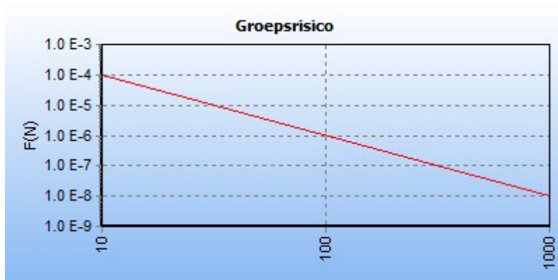
5.10 Figuur 5.10 FN curve voor 2084_leiding-N-569-80-deel-1_incl verl van N.V. Nederlandse Gasunie voor de kilometer tussen stationing 6090.00 en stationing 7090.00
