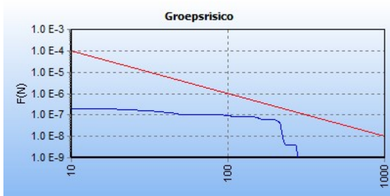
5.4 Figuur 5.4 FN curve voor 2078_leiding-A-628-deel-1 van N.V. Nederlandse Gasunie voor de kilometer tussen stationing 0.00 en stationing 0.00
