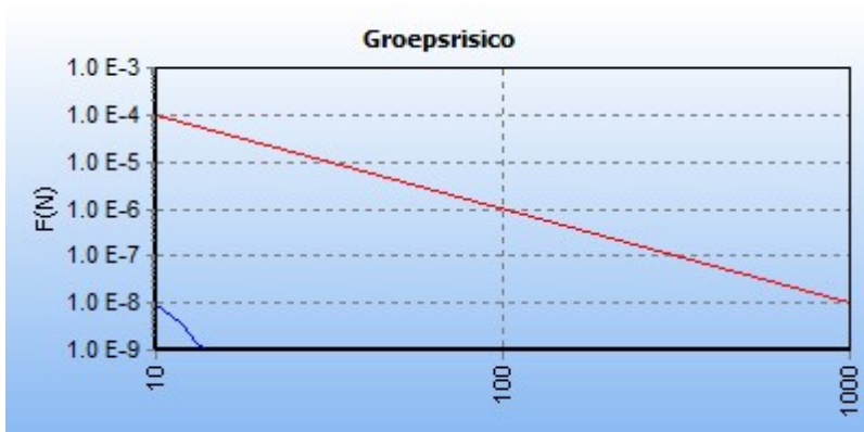
5.2 Figuur 5.2 FN curve voor 2079_leiding-N-569-66-deel-1 van N.V. Nederlandse Gasunie voor de kilometer tussen stationing 0.00 en stationing 400.00
