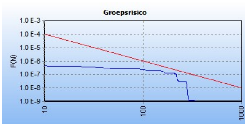
5.5 Figuur 5.5 FN curve voor 2078_leiding-A-634-deel-1 van N.V. Nederlandse Gasunie voor de kilometer tussen stationing 7370.00 en stationing 8370.00
