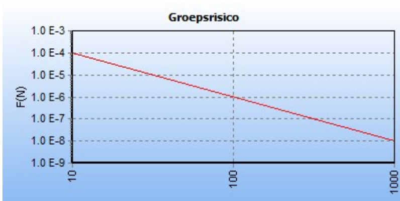
5.2 Figuur 5.2 FN curve voor 2080_leiding-A-529-04-deel-1 van N.V. Nederlandse Gasunie voor de kilometer tussen stationing 0.00 en stationing 780.00
