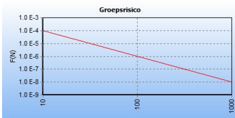
5.10 Figuur 5.10 FN curve voor 2081_leiding-N-569-84-deel-1 van N.V. Nederlandse Gasunie voor de kilometer tussen stationing 0.00 en stationing 0.00
