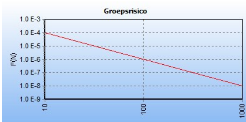
5.5 Figuur 5.5 FN curve voor 2079_leiding-N-569-82-deel-1 van N.V. Nederlandse Gasunie voor de kilometer tussen stationing 0.00 en stationing 410.00
