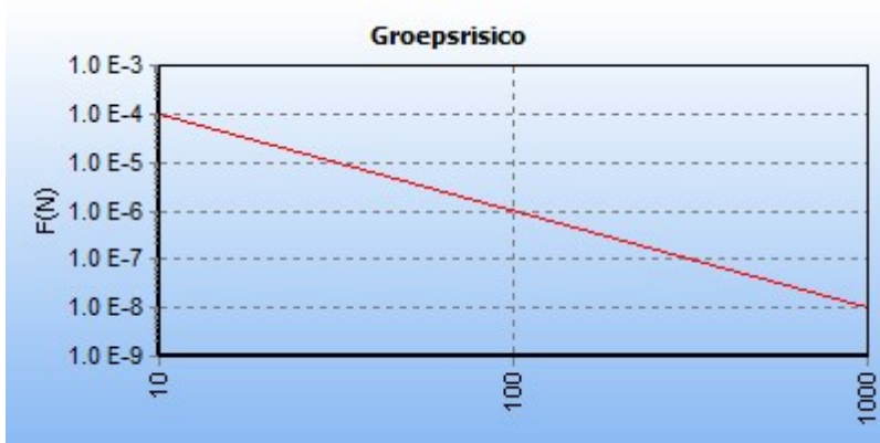
5.2 Figuur 5.2 FN curve voor 2080_leiding-A-529-04-deel-1 van N.V. Nederlandse Gasunie voor de kilometer tussen stationing 0.00 en stationing 780.00
