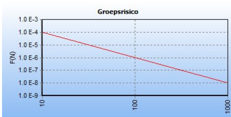
5.5 Figuur 5.5 FN curve voor 2080_leiding-A-634-deel-1 van N.V. Nederlandse Gasunie voor de kilometer tussen stationing 1610.00 en stationing 2610.00
