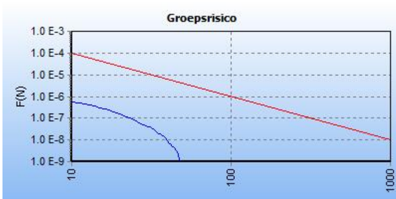
Figuur 5.2 FN curve voor 6511_leiding-W-514-01-deel-1-incl verl van N.V. Nederlandse Gasunie voor de kilometer tussen stationing 10.00 en stationing 1010.00
