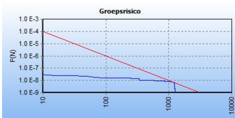
Figuur 5.5 FN curve voor 6548_leiding-A-517-deel-1 van N.V. Nederlandse Gasunie voor de kilometer tussen stationing 2740.00 en stationing 3740.00
