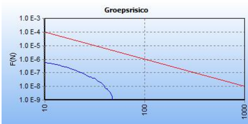
Figuur 5.2 FN curve voor 6511_leiding-W-514-01-deel-1-incl verl van N.V. Nederlandse Gasunie voor de kilometer tussen stationing 10.00 en stationing 1010.00
