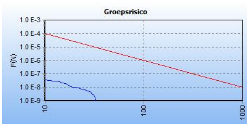
Figuur 5.8 FN curve voor 6548_leiding-W-509-06-deel-1 van N.V. Nederlandse Gasunie voor de kilometer tussen stationing 20.00 en stationing 570.00
