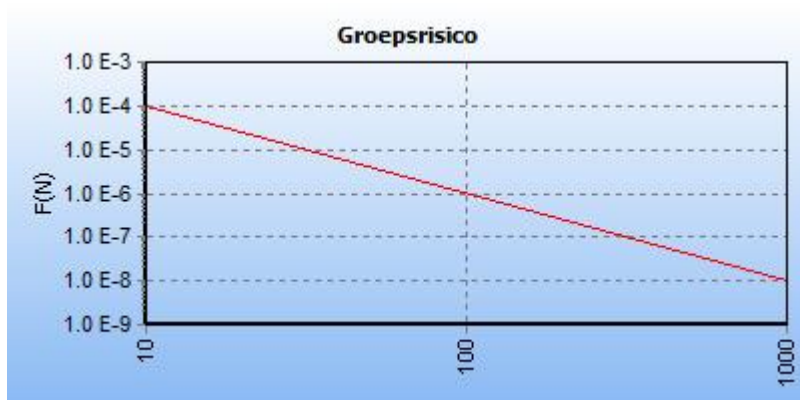
Figuur 5.10 FN curve voor 6548_leiding-W-514-10-deel-1 van N.V. Nederlandse Gasunie voor de kilometer tussen stationing 0.00 en stationing 210.00
