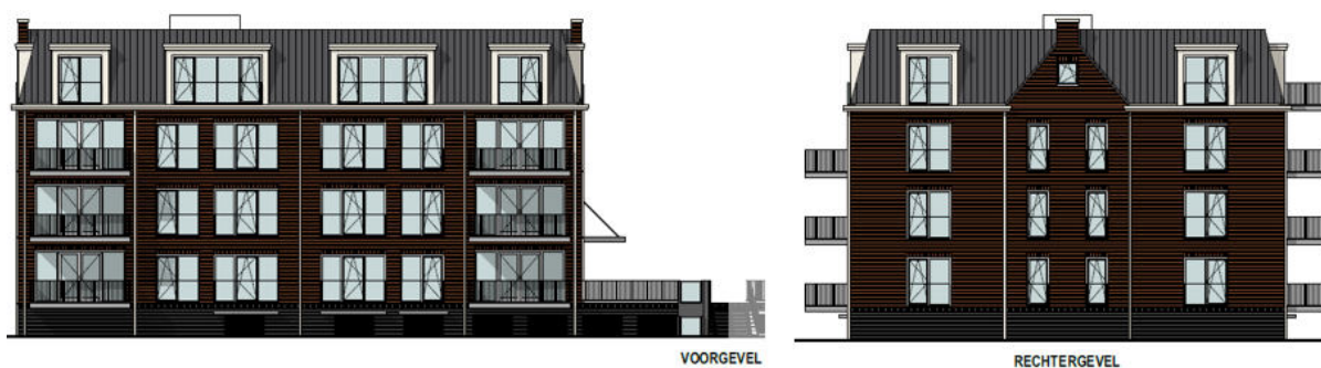
Figuur 5: Aanzichttekeningen voorgevel en rechter gevel.
