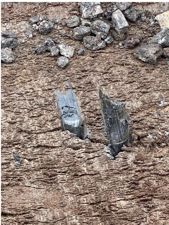
Afbeelding 14: Sleepsporen verticale drainage in Vliethaven, Leidschendam-Voorburg.
