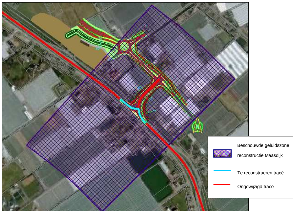
Figuur 2.5: Deel van de Maasdijk dat wordt gereconstrueerd en het beschouwde onderzoeksgebied
