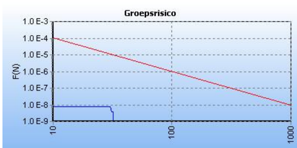
Figuur 6: FN curve van de kilometer met de hoogste overschrijdingsfactor (0.00) van de 403190. De ligging van de kilometer met de hoogste overschrijdingsfactor is hiernaast in het groen weergegeven op een topografische kaart.
