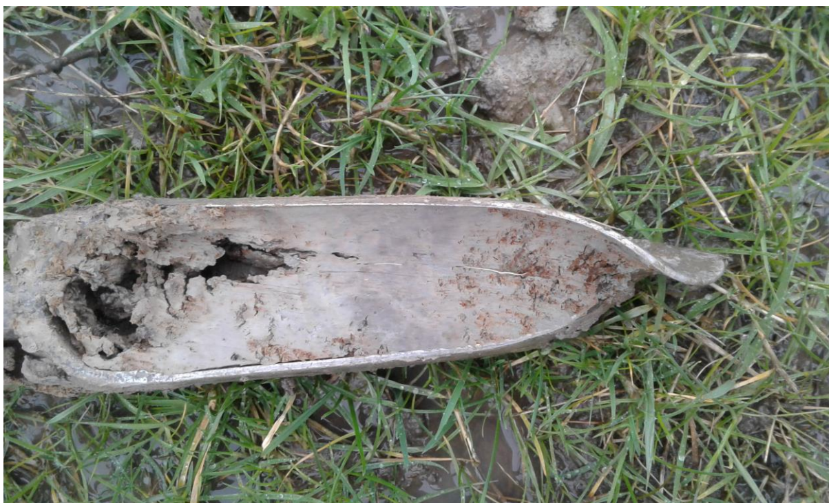
Figuur 9. Een zwak humeus traject in boring 3 (foto: RAAP).
