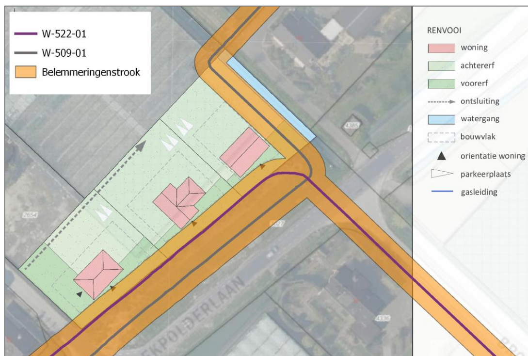
Figuur 8. Belemmeringsstrook rond aardgasleidingen
