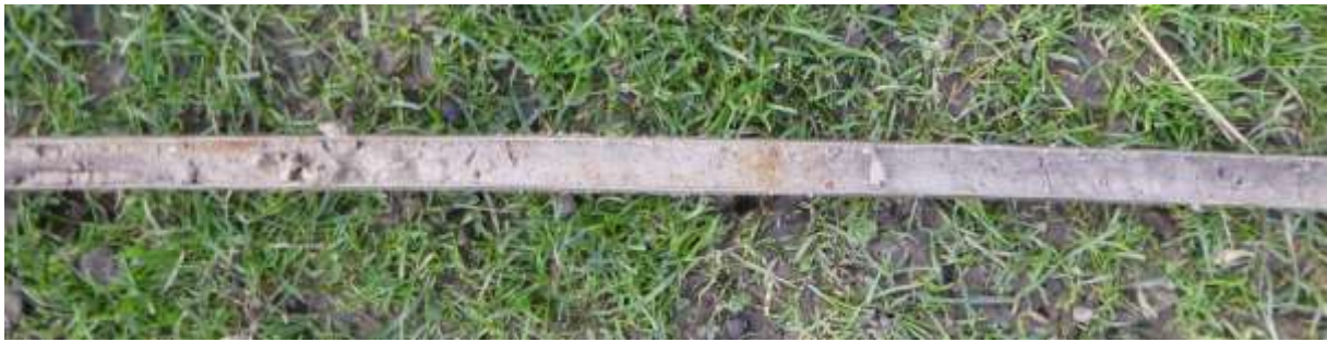
Figuur 19: Foto van het gelaagd zandpakket (midden) met rechts daarvan het gelaagd kleipakket en links waterverzadigd zand.
