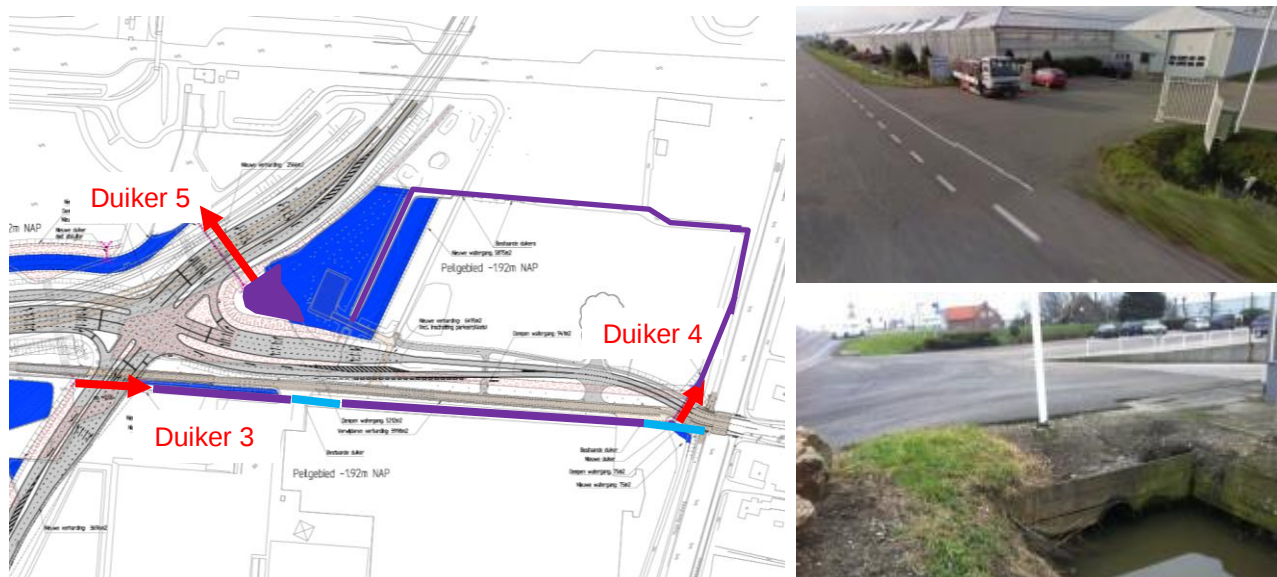
Figuur 6 – Veranderingen in het watersysteem ten zuidoosten van het gemaal. Nieuwe duikers weergegeven in rood, bestaande duikers in licht blauw en de watergangen in paars. Rechts foto's van de twee inritten met de bestaande duikers.
