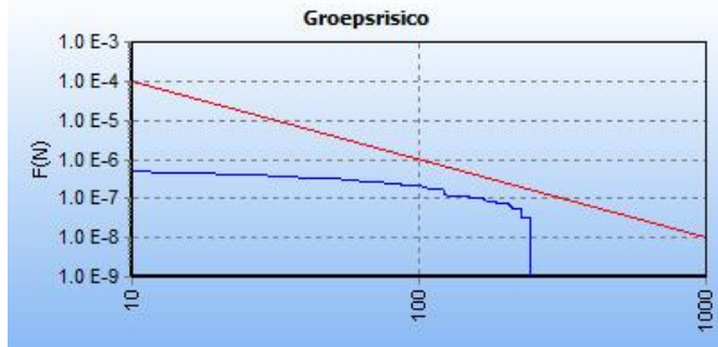
Afbeelding 4.6: FN-curve (blauwe lijn) van de maatgevende kilometer afgezet tegen de oriëntatiewaarde (rode lijn) in de huidige en plansituatie
