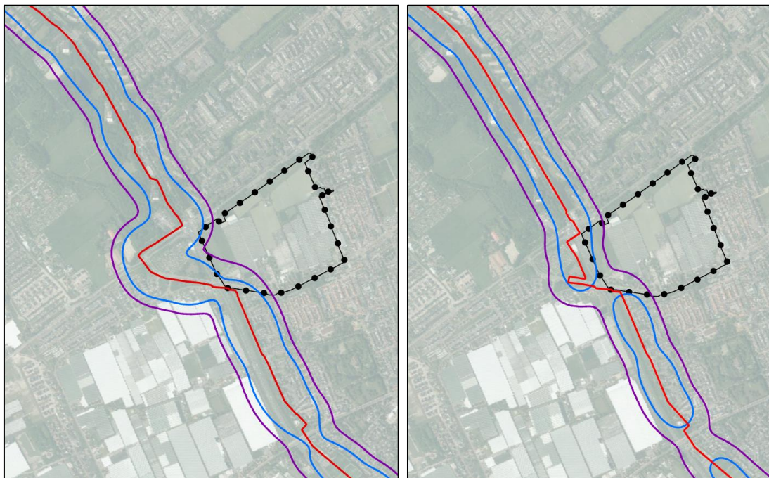
Afbeelding 4.3: Plaatsgebonden risico voor gasleiding A-617 (links) en W-509-02 (rechts) - blauwe contour = PR 10^{-7} en paarse contour = PR 10^{-8}
