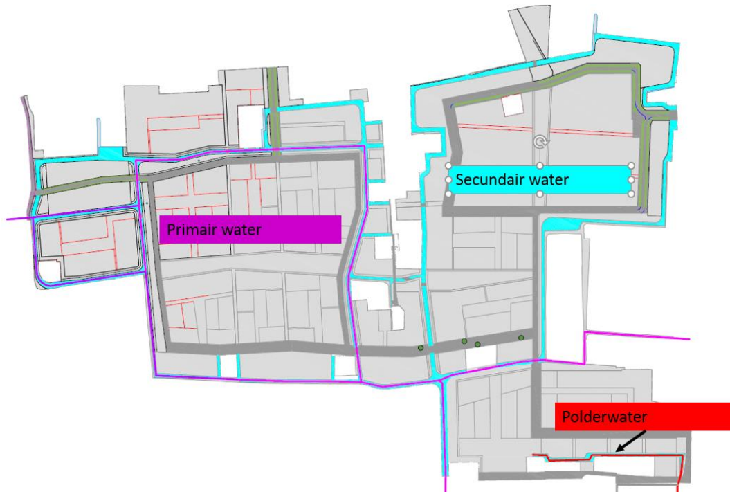
Afbeelding 2.4 Overzicht primair, secundair en polder watergangen
