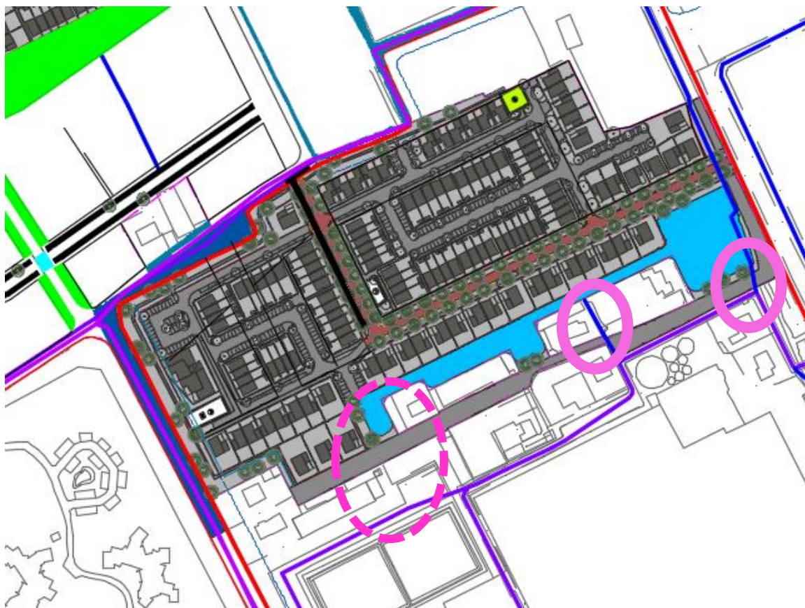
Afbeelding 3.5 Op deze kaart zijn de duikers weergegeven (roze) die de nieuwe polderwatergang verbinden met het bestaande systeem. De gestippelde cirkel geeft de locatie weer van een mogelijke extra duiker
