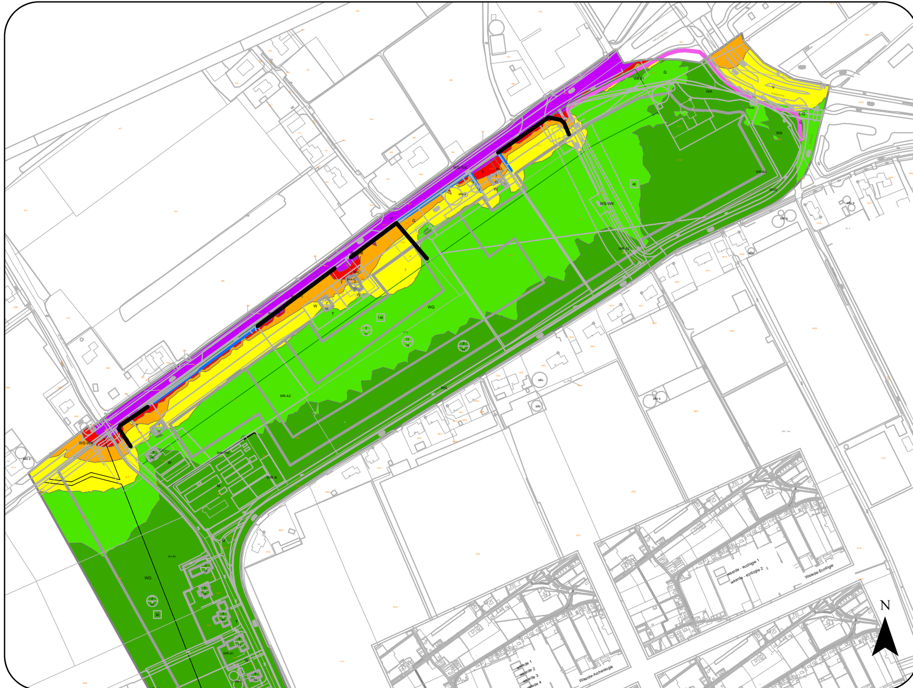
Geluidcontour ten gevolge van de Wateringseweg/Erasmusweg(inclusief correctie conform art. 110g Wet geluidhinder) met schermmaatregelen
