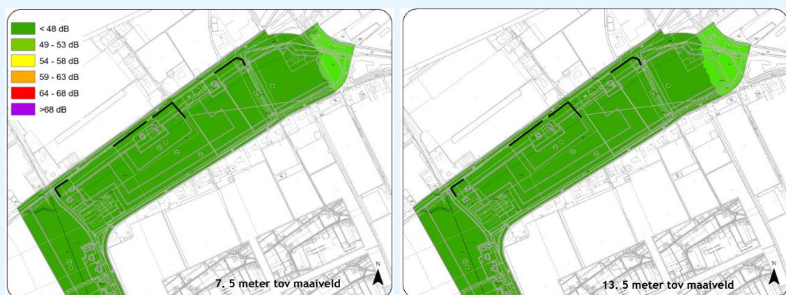
figuur 5: geluidsniveau t.g.v. Lozerlaan/Wippolderlaan op 7.5m en 13.5m hoogte (incl. aftrek conform art. 110g Wgh)
