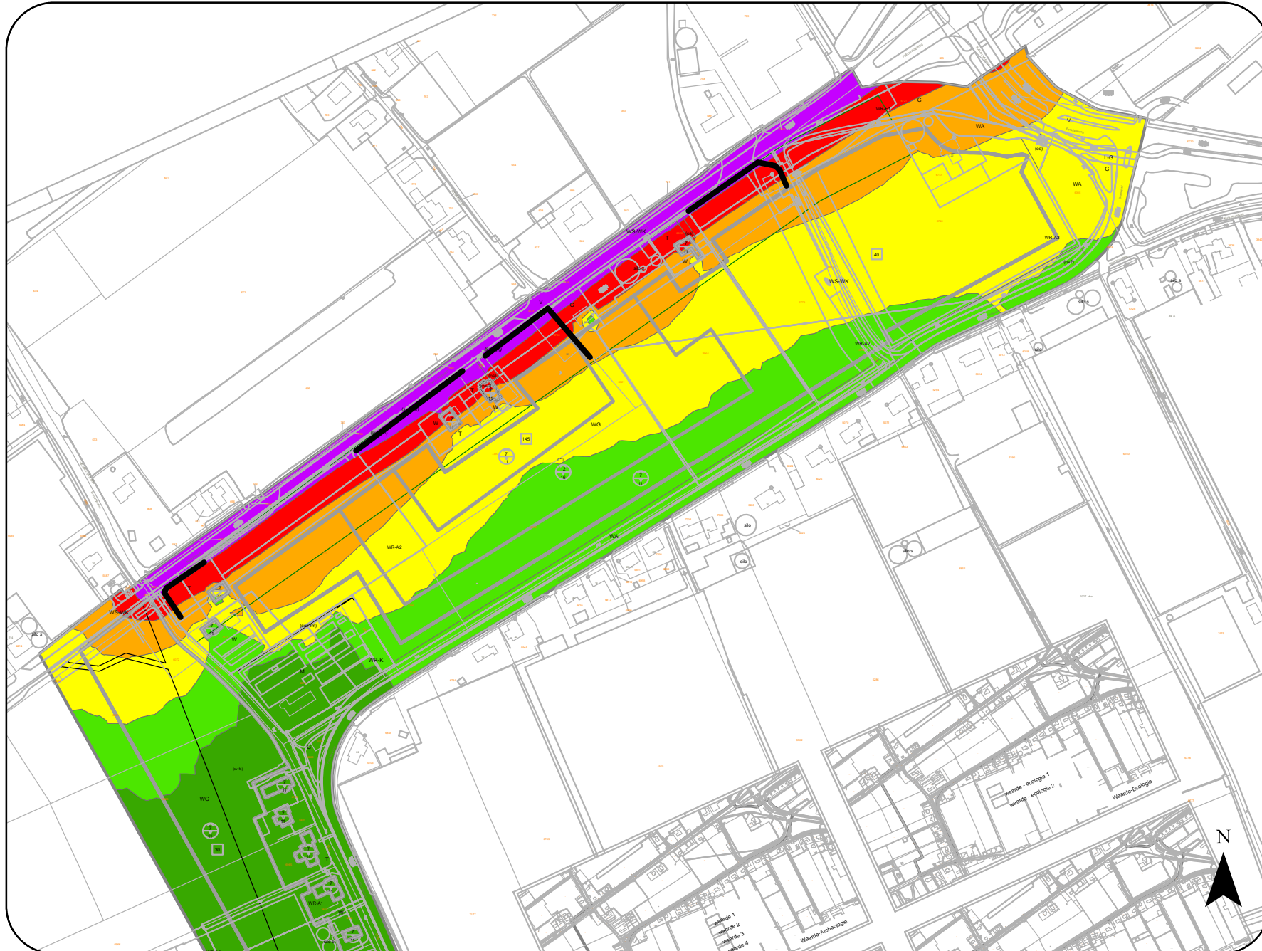
Geluidcontour ten gevolge van de Wateringseweg/Erasmusweg (inclusief correctie conform art. 110g Wet geluidhinder)
