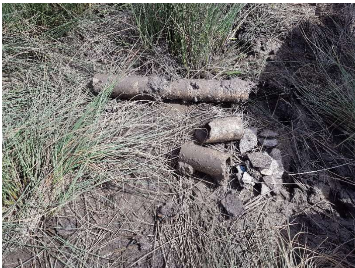
foto 11: asbestverdacht materiaal sleuf 20
