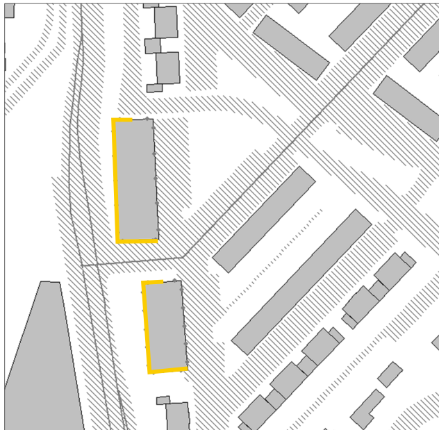
Figuur 4.2: Geveldelen waarvoor sprake is van een overschrijding van de voorkeursgrenswaarde ten gevolge van de nieuwe ontsluitingsweg
