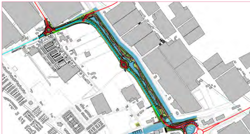
Figuur 5.1: Locaties waarvoor is uitgegaan van geluidsreducerend asfalt (-3 dB)
