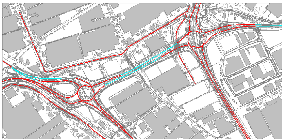
Figuur 5.6: Wegvakken waarvoor in het kader van dit onderzoek uitgegaan is van geluidsreducerend asfalt
