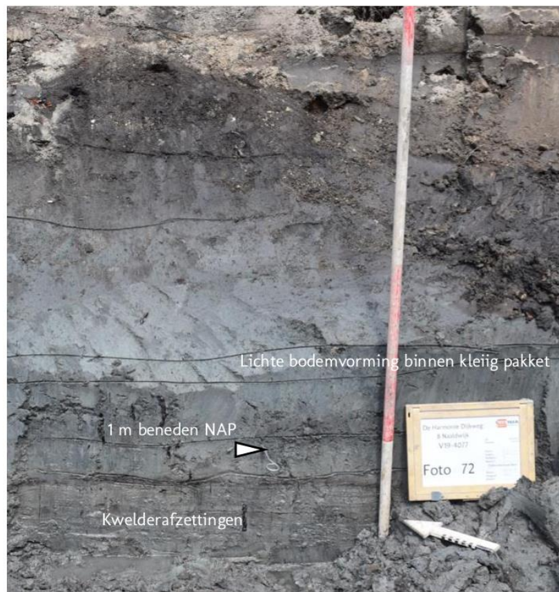
Afbeelding 4.5: Afwisseling zand- en kleilaagjes op een dieper niveau als bewijs voor kwelder-/getijde-afzettingen.
