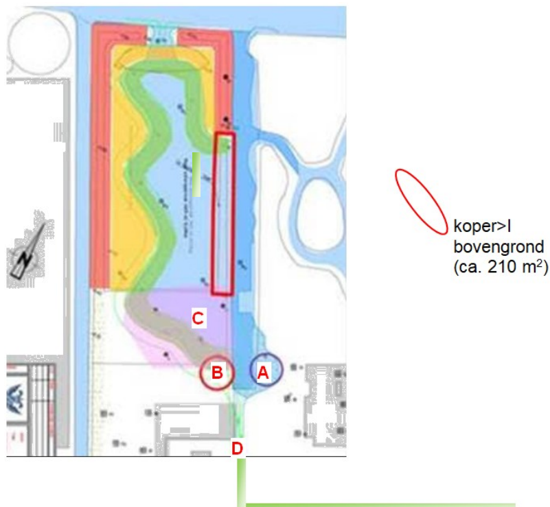
Afbeelding 1: schets van de nieuwe situatie; De huidige sterk verontreinigde dijk is rood gekleurd, de grond binnen het rode kader dient te worden ontgraven; rechts, in het verlengde van de afbeelding, is globaal de ligging van de sterke koperverontreiniging aangegeven en aan de zuidkant de te graven sloot D; de kas rechtsonder is al weg.
